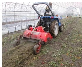
残さ破碎状況
