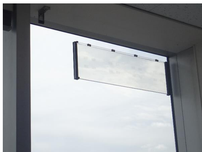
写真 : NTT ドコモが開発したガラス状の基地局。大きさは 7cmx20cm と小さく、重さは 1.9kg しかない (出典 : NTT ドコモ報道資料)
