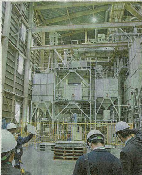
新篠津村農協の米乾燥調製施設「ライスファクトリー新しのつ」内にある異物除去施設。高品質なコメ輸出を支えている
